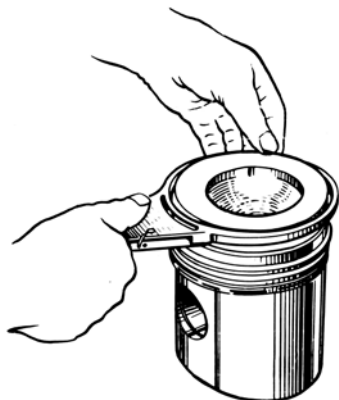
Рис. 95. Снятие и надевание поршневых колец на поршень
