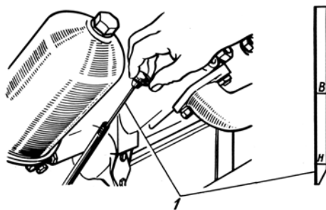
Рис. 66. Проверка уровня масла в поддоне двигателя: 1—указатель уровня масла.
